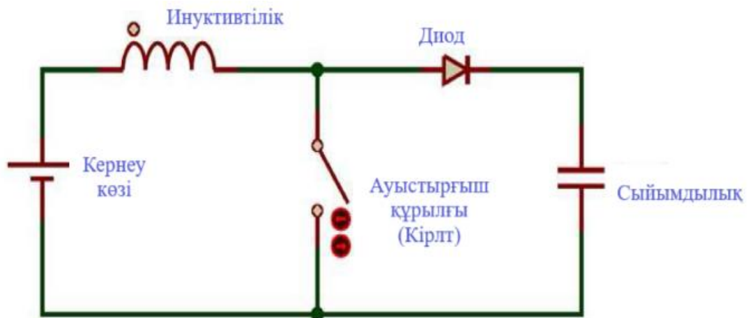
2.3 – сурет- Тұрақты ток күшейткіш түрлендіргішінің схемасы
